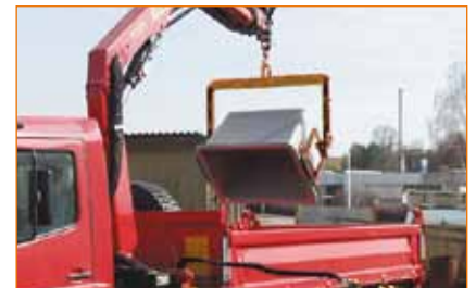
Auskippen des Streugutes auf die LKW-Pritsche (Beispiel mit Streugutbox 700 l)
